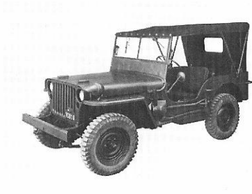
Jeep Kaiser 1944 (Baujahr des abgebildeten Fz) 4x4 0,46t (tot. Anz. Räder x Anz. Angetr. Räder) ( Nutzlast) Benzin (Betriebsstoff)
